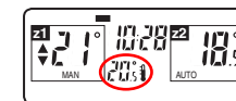
La temperatura medida por el mando central se muestra junto a la ventana Z1 .
